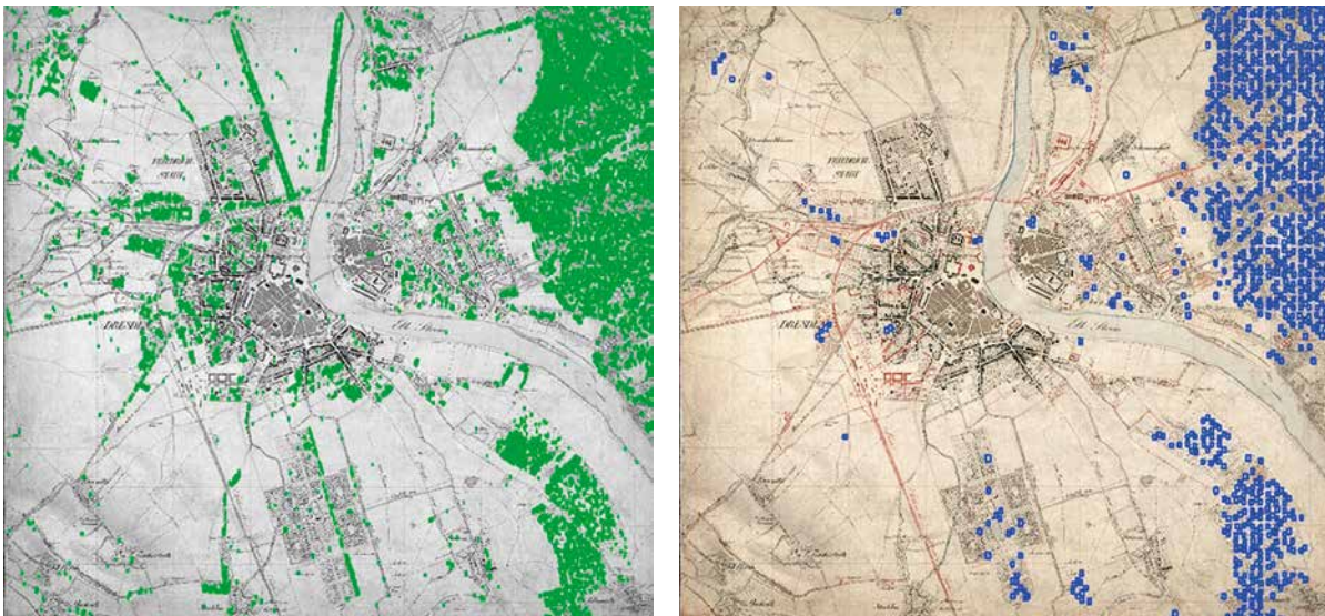
Abb. 4: Vergleich der Detektions-Ergebnisse von TM (links) und YOLO-Netzwerk (rechts) im Sächsischen Meilenblatt „Dresden“. Die großen Waldgebiete in der Dresdner Heide und linkselbisch sind mit guter Übereinstimmung detektiert.
