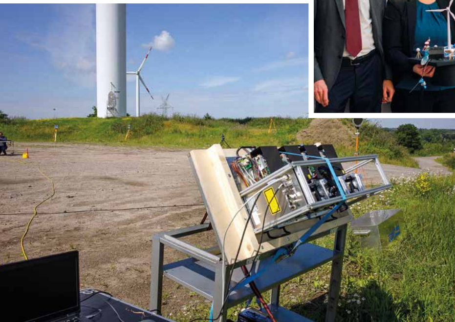
Abb. 2: Mit dem neuartigen Messverfahren von Göring lassen sich Verformungen an den Rotorblättern von Windenergieanlagen analysieren, ohne sie stillzulegen (Foto: Jade HS/Göring).
