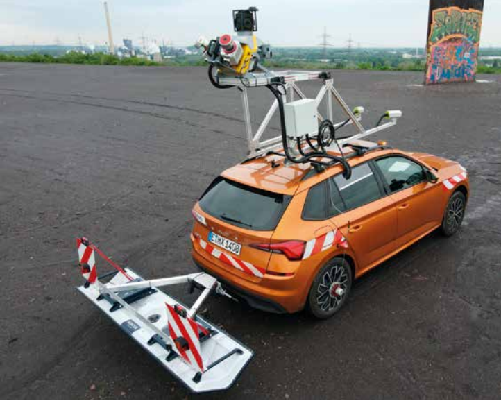
Abb. 1: Mit diesem Messfahrzeug kann die Stadt Essen Panorama- und Laserscan-bilder aufnehmen, die für Zwecke von der Straßenzustandsbewertung bis hin zur kommunalen Wärmeplanung genutzt werden (© Disy Informationssysteme GmbH).
