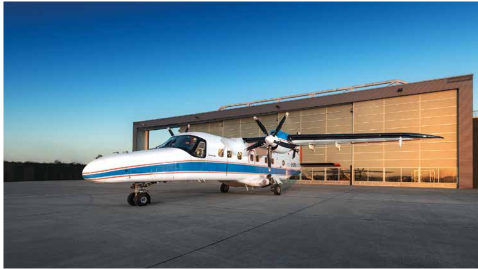
Abb. 6: DLR-Forschungsflugzeug DO 228-212 D-CFFU. Das Flugzeug ist robust, zuverlässig und so modifiziert, dass es sich ideal für umfangreiche wissenschaftliche Nutzlasten eignet. Das Flugzeug dient als Mess- und Erprobungsplattform insbesondere für die Bereiche Fernerkundung, Erdbeobachtung und Verkehrsforschung sowie zur Erprobung innovativer Radarsysteme. Die beiden leistungsstarken Turboprop-Triebwerke erlauben dabei auch Einsätze auf unbefestigten Oberflächen. Betrieben wird die DO 228-212 D-CFFU von der DLR-Einrichtung Flugexperimente in Oberpfaffenhofen (DLR: CC BY-NC-ND 3.0).
