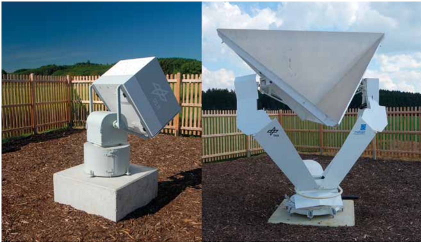
Abb. 4: Transponder und Winkelreflektor zur Kalibrierung von Sentinel-1D. Das DLR SAR Calibration Center am DLR-Institut für Hochfrequenztechnik und Radarsysteme fungiert seit 2014 als zentrale Kalibriereinrichtung für die Sentinel-1-Mission. Transponder und Winkelreflektoren dienen als Referenzziele, gegen die die Radarsysteme kalibriert werden. Sie befinden sich verteilt über einen mehr als 100 Kilometer breiten Streifen westlich von München (DLR: CC BY-NC-ND 3.0).
